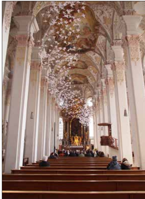
Abb. 1: Ein Kirchenschiff mit sehr hoher Decke, glattem Putz und Marmorboden in den Seitenschiffen hat natürlich lange Hallzeiten. Hier sind Line-Arrays im Vorteil, ohne dass dabei auf Musikfähigkeit verzichtet werden muss.
