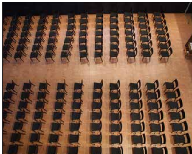
Abb. 4: Ein häufiges Problem ist ein Gestühl, das für Schall sehr durchlässig ist und den Raummoden kaum Widerstand bietet. Zusätzlich ist der Boden dabei massiv und mit glatter Oberfläche ausgeführt. Das Ergebnis einer solchen Innenarchitektur ist ein sehr hohes Maß an Diffusschall und damit verbunden eine schlechte Sprachverständlichkeit.
